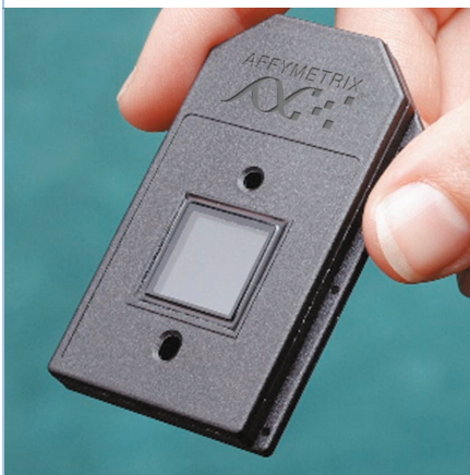
● Abb. 1: Expressionschip der amerikanischen Firma Affymetrix. Ein solcher Chip samt Gehäuse hat etwa die Größe einer Streichholzschachtel.
